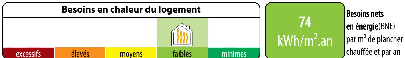
Ces besoins sont les apports de chaleur à fournir par le chauffage pour maintenir constante la température intérieure du logement. Ils dépendent des pertes par les parois selon leur niveau d'isolation thermique, des pertes par manque d'étanchéité à l'air, des pertes par la ventilation mais aussi des apports solaires et des apports internes.
